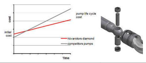
Wartung: Bei der Entwicklung der Diamond Baureihe haben wir darauf geachtet, dass die Wartung einfach, und mit wenig Tausch-Teilen durchzuführen ist. Bei den Gelenkbuchsen z.B. kann man Bolzen und Buchsen einzeln tauschen, ohne dass Rotor oder Wellen ersetzt werden müssen. In der Summe ergeben sich aus Kaufpreis der Pumpe und niedrigen Wartungskosten äußerst wettbewerbsfähige Life-Cycle Kosten, die keinen Vergleich scheuen müssen.
